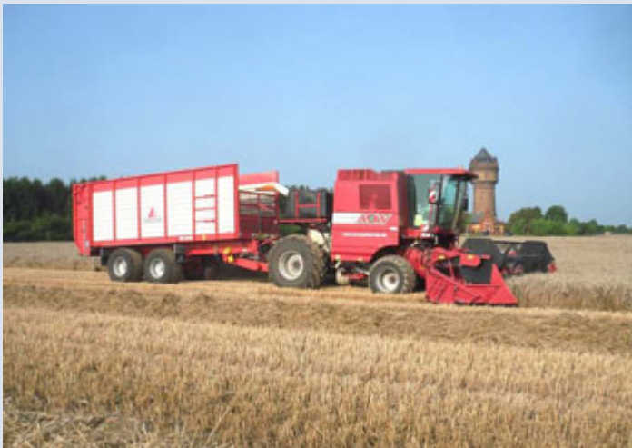
Der Kompakternte-Mähdrescher erntet Korn, Spreu und Stroh in nur einer Überfahrt.
